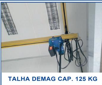
TALHA DEMAG CAP. 125 KG
