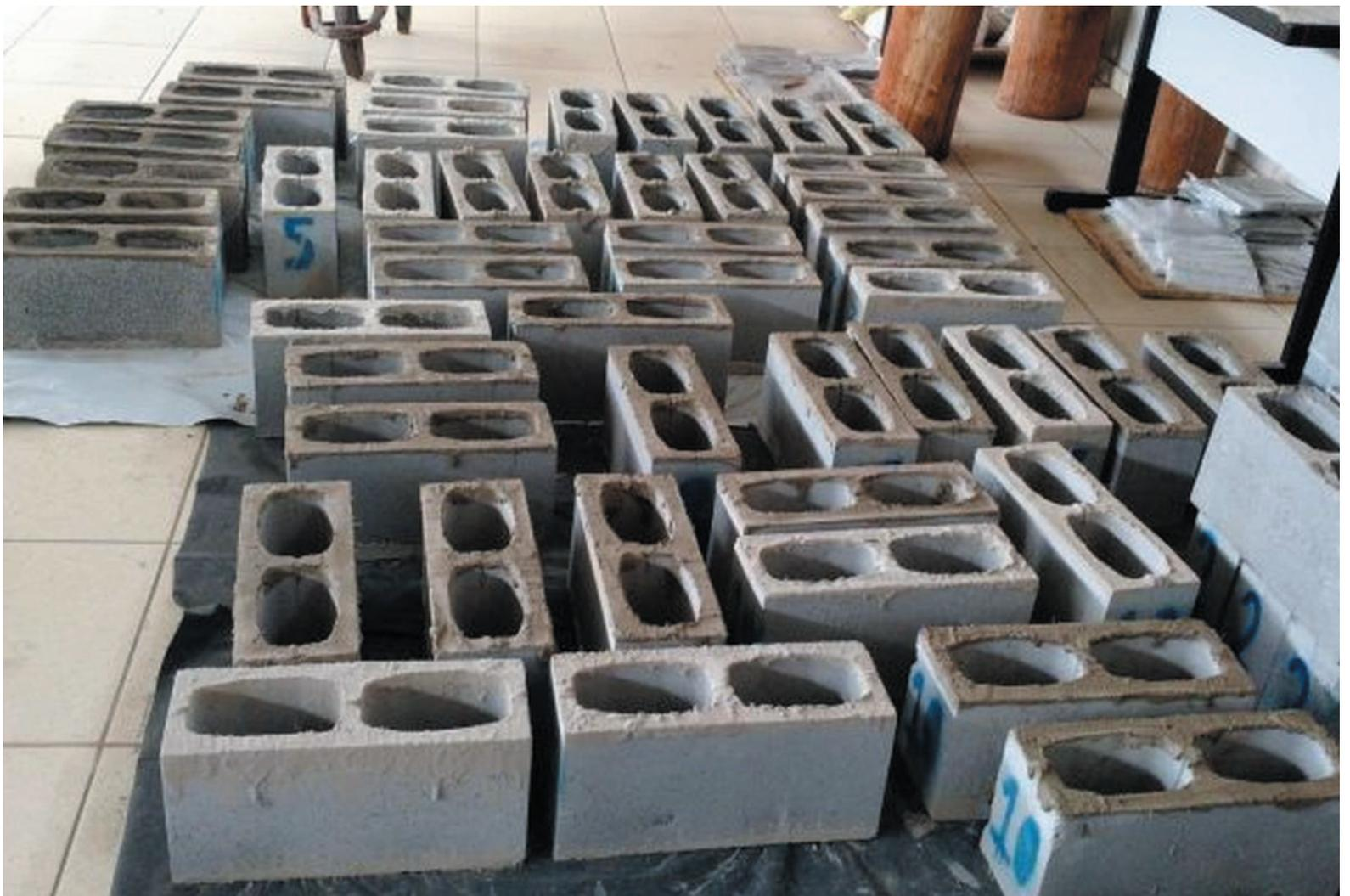
Resultados indicam que a substituição parcial de areia por "pó" de quartzito e a adição de fibras de coco podem melhorar propriedades dos blocos de concreto, como a resistência à compressão
